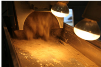
スプレードライヤー（出口）
